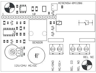
Der RJ12-Steckverbinder ist für den direkten Anschluss an das Sensor-Schaltmodul vorgesehen (SENSOR Buchse). Über den "ADJUST" Potentiometer kann der passende Schaltpunkt eingestellt werden.
