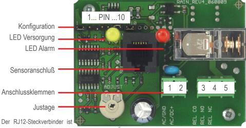
Leckagemelder vorgesehen (Sensoranschluss). Über den "ADJUST" Potentiometer kann der passende Schaltpunkt eingestellt werden.
